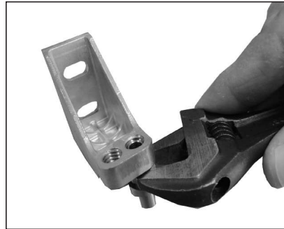
8. Die Achse des oberen Scharniers mit einem Schraubenschlüssel heraus drehen.
