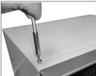
17. Die vier Schrauben wieder in die obere Bedientafel eindrehen
