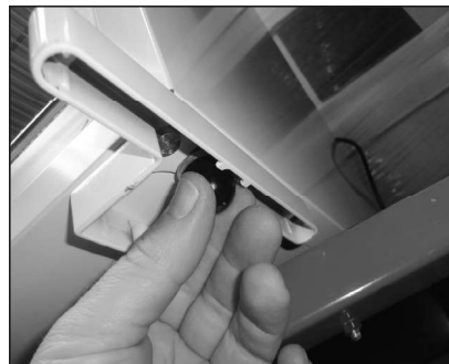
10. Unter dem unteren Scharnier den Fuß abschrauben und...
