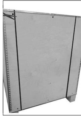
2. Coupez les bandes Strapex ou voir la page suivante s'il est scellé par clips en plastique
