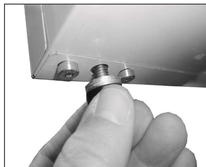
12. Auf der gegenüber liegenden Seite: Fuß und Schrauben abnehmen...
